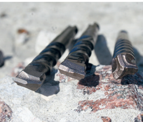
Слева направо: Prefix, Bionic Pro, Trijet. Первые два — двухкромочные, но у Bionic Pro твердосплавная напайка более сложной формы. Trijet — трёхкромочные буры
